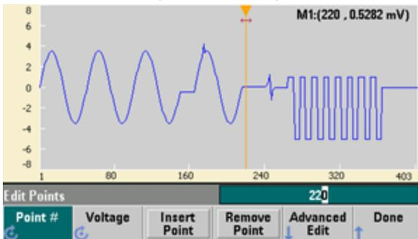
3. Sie können Punkte auch bearbeiten, indem Sie eine Spannungstabelle verwenden. Drücken Sie auf **Advanced Edit > Edit Via Table**. Setzen Sie **Point #** auf 200 und stellen Sie dann **Voltage** für Punkt 200 auf 3 V. Verwenden Sie den Drehknopf zum Navigieren in den Zeilen und stellen Sie den Wert **Voltage** für Punkte 205 und 210 auf 3 V. Drücken Sie **Done**.
