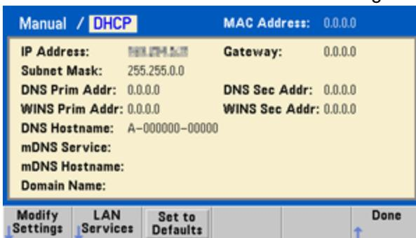
**HINWEIS** Dieser Bildschirm spiegelt das 33500 Series Display wider. Zur 33600 Series gehört auch eine Statusanzeige oben rechts, die anzeigt, ob die LAN-Verbindung korrekt oder fehlerhaft ist.
