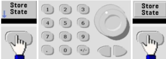
Die Statusdatei wird mit der Erweiterung .sta angelegt, mit dem Namen, den Sie über Drehknopf und Pfeile angeben
