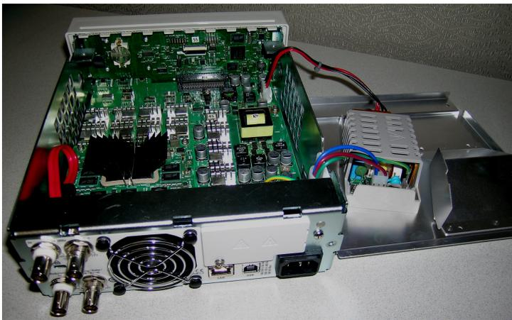
3. Entfernen Sie die beiden Schrauben von der Hauptplatine. Diese befinden sich direkt unterhalb der beiden Schrauben, die Sie im ersten Schritt entfernt haben.
