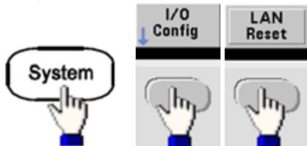
Die Meldung "Performing LAN Reset" wird angezeigt, während das LAN zurückgesetzt wird.
